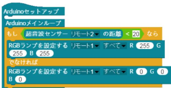
Arduino モードで、上記のプログラムを参考に、人を感知して ON/OFF できるスタンドライトを作成できる。
